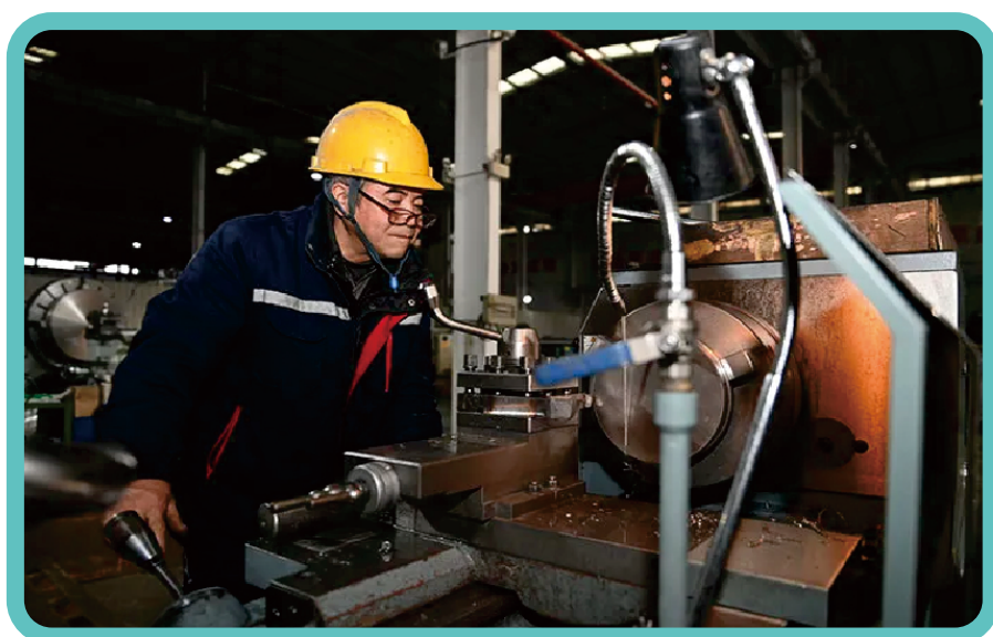
宝鸡市永盛泰钛业有限公司机加车间 工人操作车床加工高速压缩机叶轮钛合金锻件
